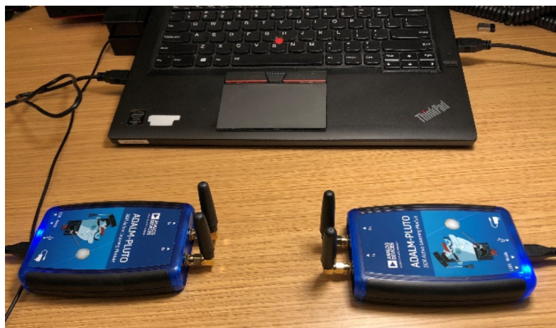
図 9. ADALM-PLUTO を使用したソフトウェア無線システム (左) と対応する混同行列 (右)
